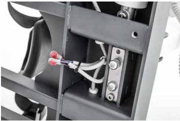
Herausdrehen zweier Schrauben
