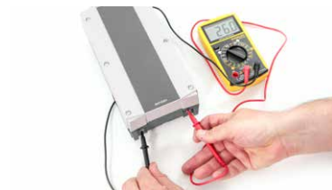
Überprüfung der Spannung der Batterie
