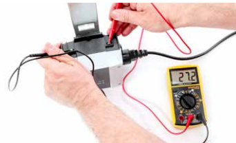
Überprüfung der Spannung des Ladegerätes
