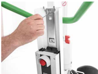
Twee schroeven losdraaien
