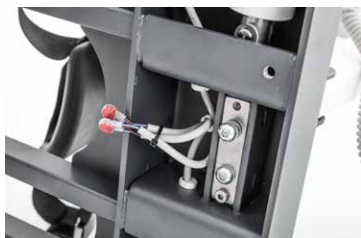
Draai twee schroeven los
