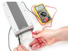
Überprüfung der Spannung der Batterie
