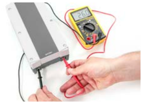
Spanning op de batterij controleren
