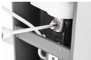
Veiligheidsring en pen verwijderen
