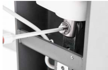
Entfernen des Sicherheitsrings und des Stifts
