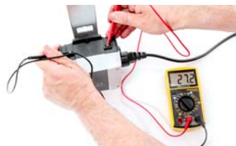
Überprüfung der Spannung des Ladegerätes
