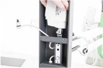
Entfernen des zweiten Stifts
