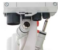
Überprüfung der Kabelverbindung
