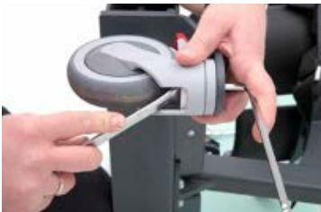
Ersetzen der hinteren Rollen
