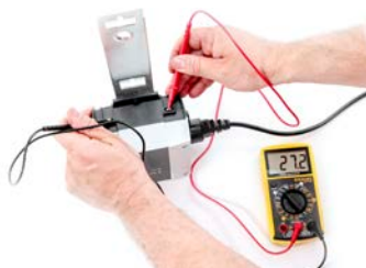
Kontrollera spänningen hos laddaren
