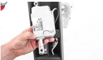
Motor uit het frame nemen
