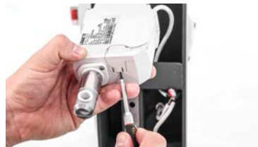
Verwenden Sie Flachklingen-Schraubendreher
