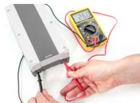
Kontrollera spänningen hos batteriet
