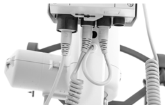
Prüfen der Kabelverbindung
