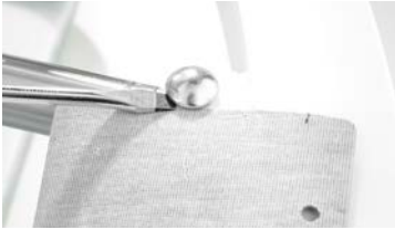
Stervormige dop verwijderen
