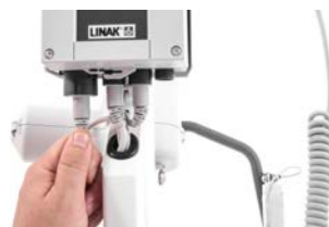
De aansluiting van de bekabeling controleren
