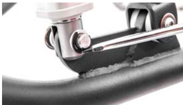
Entfernen des Sicherungsring (zweite Seite)
