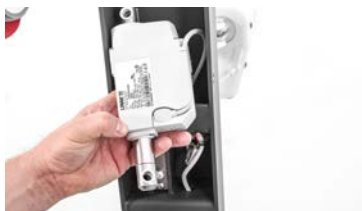
Herausnehmen des Motors aus dem Rahmen
