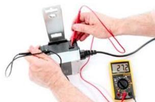
Überprüfung der Spannung des Ladegerätes
