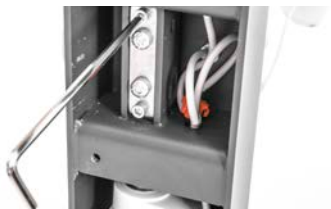
Eerste schroef verwijderen
