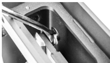
Entfernen der ersten Schraube
