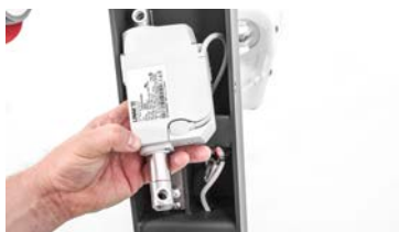
Aandrijvingscilinder uit het frame nemen
