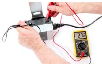
Spanning op de lader controleren
