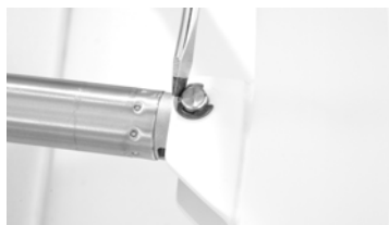
Entfernen des Sicherungsringes
