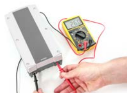
Überprüfung der Spannung der Batterie
