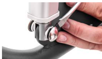
Stervormige dop verwijderen (tweede kant)
