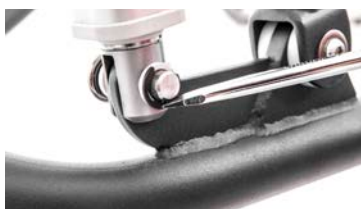
Circlip verwijderen (tweede kant)
