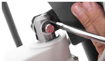
Entfernen des Sicherungsring
